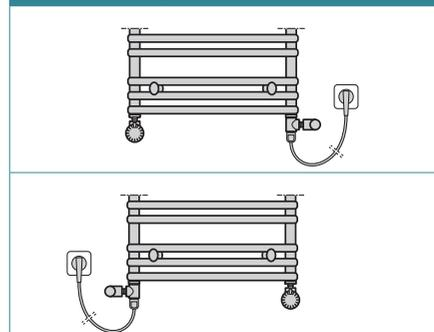
**Spezial-Anschlussstück** (verchromt) für den Elektroheizeinsatz beim DION gebogen Badheizkörper zu verwenden!
