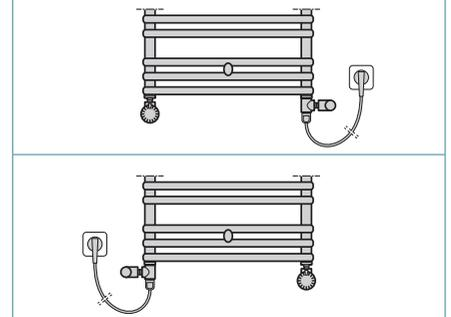
**Spezial-Anschlussstück** (verchromt) für den Elektroheizeinsatz beim DION Badheizkörper zu verwenden!
